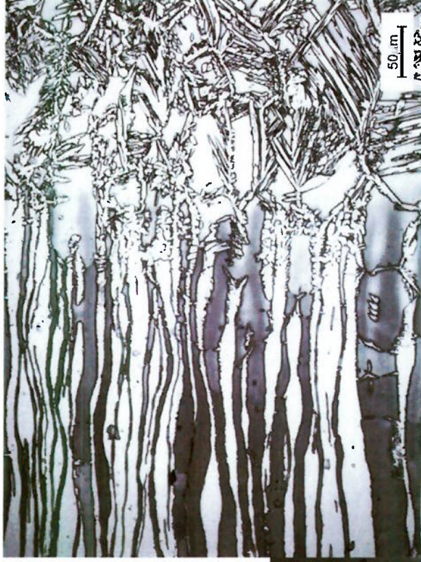
Zona Afetada pelo Calor
