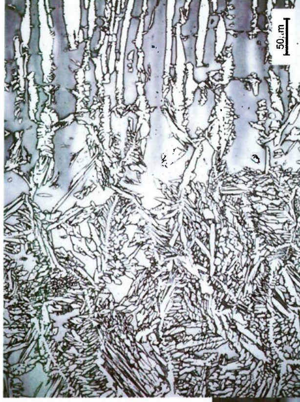
Zona Afetada pelo Calor
